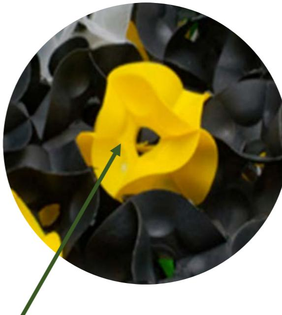
Estrutura plástica cunha alta superficie específica ( $>160m^2/m^3$ ) para formación de biopelícula, coio deseño facilita o paso da auga e a aireación por tiro natural
